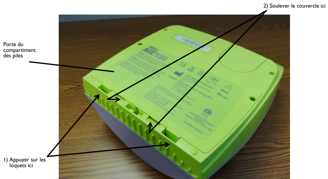
Figure 7 : Retrait de la porte du compartiment des piles
