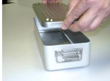
2. Lösen Sie mit Hilfe eines schmalen Gegenstandes (z. B. Schraubenzieher) die Dichtung aus der Deckelnut und ziehen Sie die Dichtung heraus.
